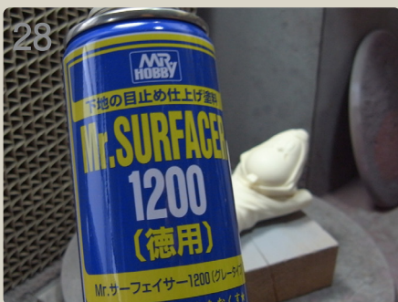
下地用塗料(サーフェーサー)を吹き付けます。
